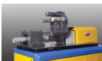
Sistema manuale porta utensili a sei posizioni Manual tool holder system with six position
