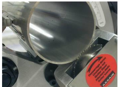
Montage outil à l'extérieur
