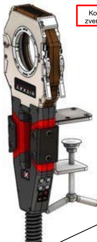
Konfigurácia konzoly na skrutkovú montáž na pracovný stôl
