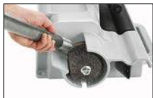
Volitelný odhrotovací kotouč se používá k odstranění vnějšího ořepu pro pomoc s těsnými tvarovkami
